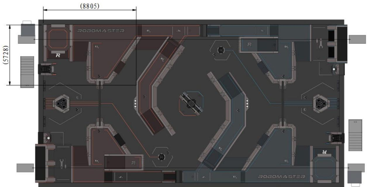
图 2-25 R0 定位标签定位尺寸图
