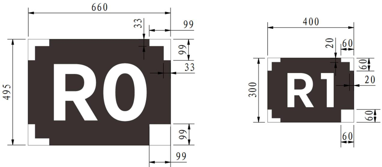
图 2-48 定位标签尺寸示意图
