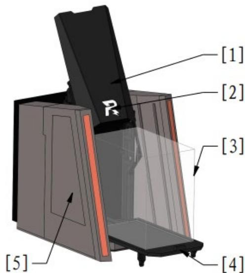
[1] 闸门 [2] 状态指示灯 [3] 飞镖发射架放置空间 [4] 滑台 [5] 发射站主体
