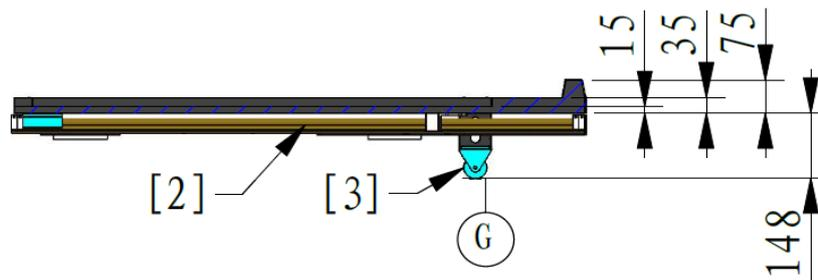
[1] 飞镖发射架放置平面 [2] 滑台轨道 [3] 支撑轮
