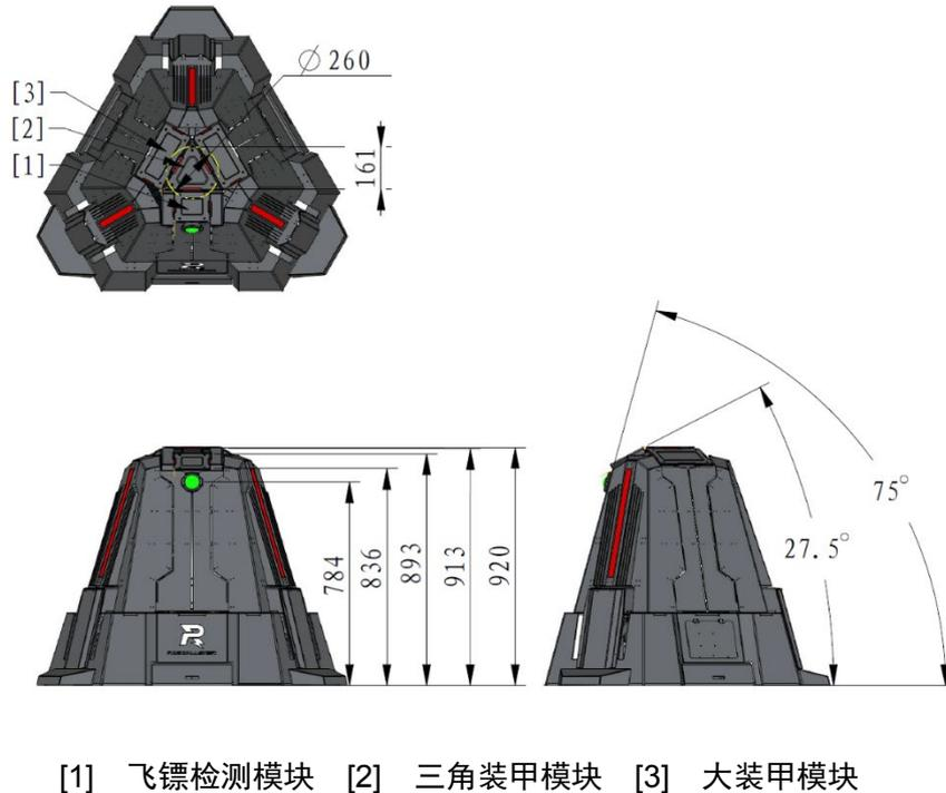
图 2-8 基地护甲闭合形态尺寸图
