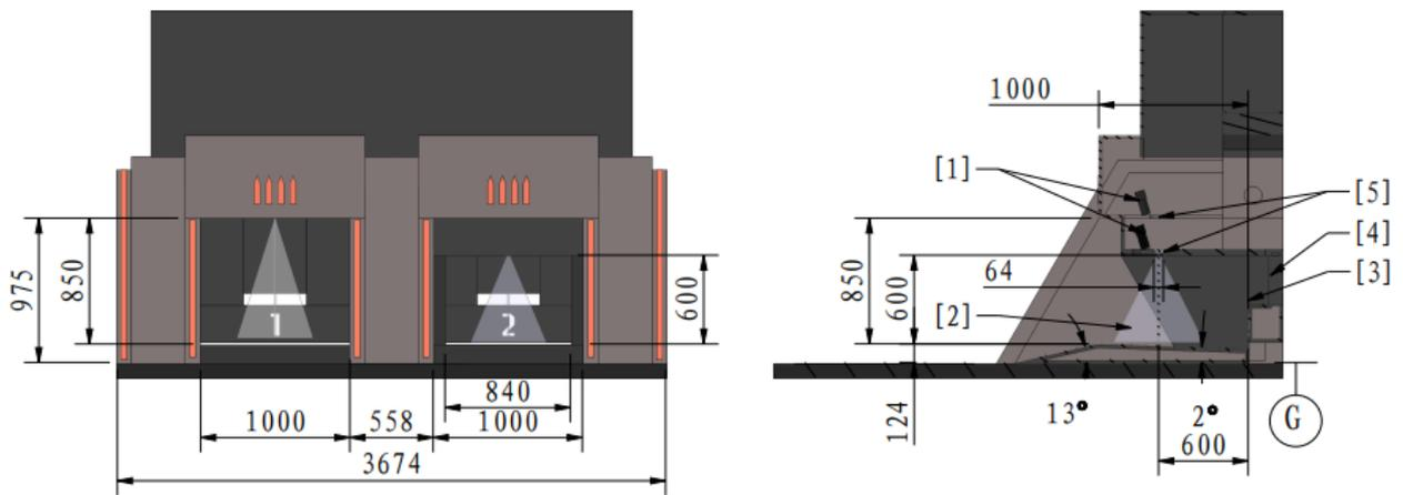
[1] 摄像头 [2] 激光光路 [3] 钢丝网 [4] 显示器 [5] 出弹口
