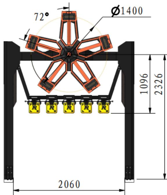
图 2-35 能量机关示意图
